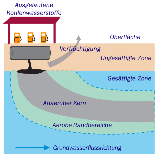
Abb. 10: Profil einer Grundwasserspür bei Anwendung moderner Remediations-Technik
