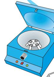
Las células se separan del líquido por medio de centrifugación
